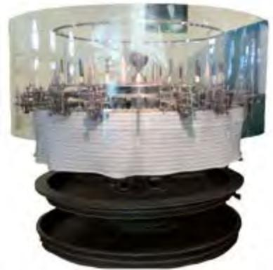
Avec un métier circulaire, on obtient un tissu en forme de tube.
